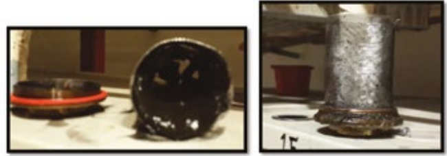
Kimyasal Yıkama Öncesi & Sonrası Pislik Tutucu Filtreler
