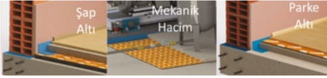
Şekil 13. Ses izolasyon malzemelerinin uygulama alanları.
